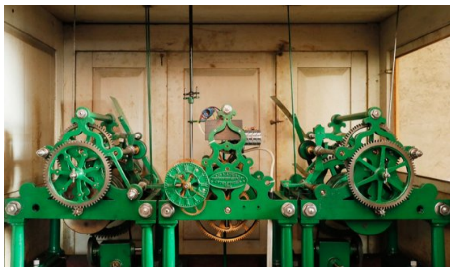
Präzision im Minutentakt: Das Uhrwerk der Turmuhrfabrik J. B. Mäder aus Andelfingen von 1886 wird inzwischen elektronisch gesteuert.
